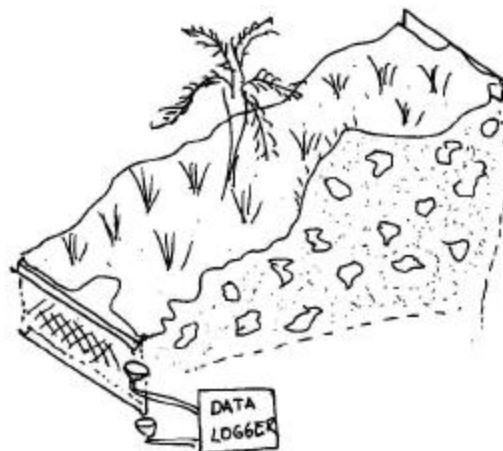
Fig. 4 Colectores de escorrentía y filtración lateral
